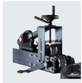
Schlauchmessgerät zum Abmessen der benötigten Schlauchlänge Hose measuring device to measure the needed hose length
