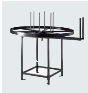
Große Haspel zum Lagern und Ablegen von Schlauchleitungen Ø 1200 mm LxBxH 1450x1300x1200 mm Gewicht 90 kg
